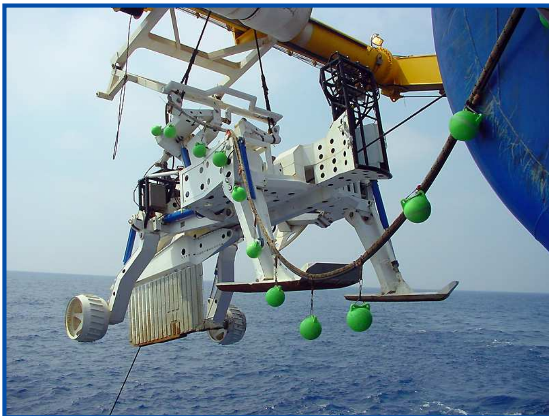
Charrue sous-marine utilisée pour l'ensouillage des câbles sous-marins (© GNU Free Documentation License)
