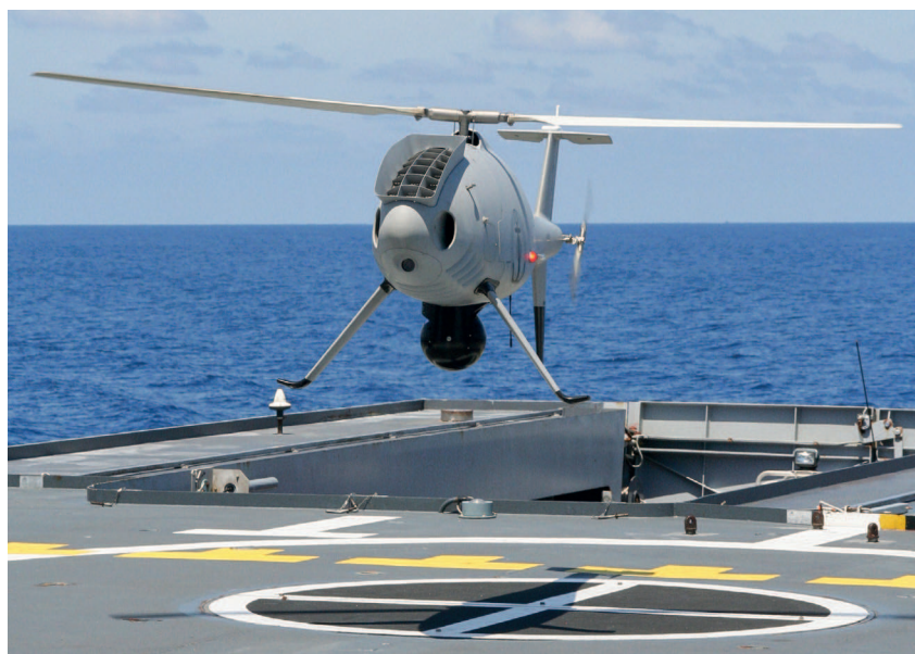
Le drone S-100 Camcopter , aussi appelé SERVAL pour Système embarqué de reconnaissance vecteur aérien léger. Ici en essai avec le patrouilleur Adroit . © Marine nationale / M. Grozel.
