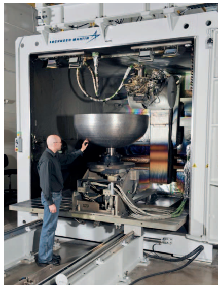
Imprimante 3D métal par faisceau d'électrons (EBAM). © Lockheed Martin.
